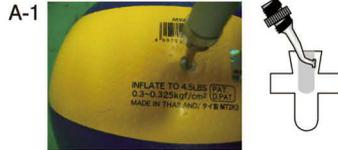
Das Reparatur Werkzeug wird mit der Nagelvorderseite (siehe Abb. 1) bis zur Nagelkrümmung in das Ventil eingeführt.
